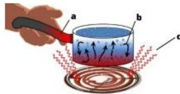
Ilustrasi tersebut menggambarkan peristiwa perpindahan kalor ketika memasak air. Jelaskan cara perpindahan kalor pada bagian a, b, dan c!
