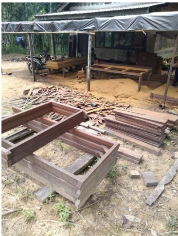
Mendokumentasikan hasil pengolahan kayu ulin berupa kerangka jendela
