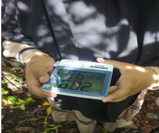
Pengukuran Suhu & Kelembaban Udara
