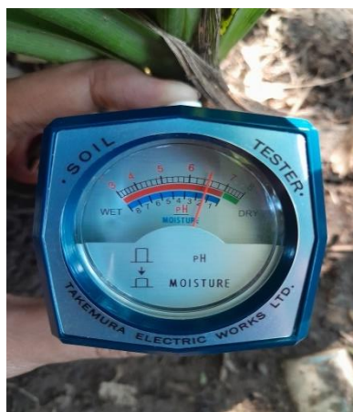
Pengukuran Kelembapan Tanah
