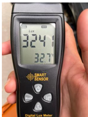
Pengukuran Intensitas Cahaya dan Suhu Menggunakan Lux Meter
