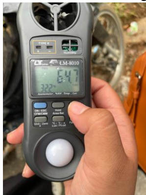
Pengukuran Suhu dan Kecepatan Angin Menggunakan Lutron 4 in 1
