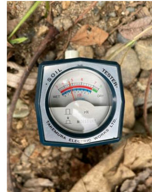
Pengukuran Parameter Lingkungan Menggunakan Soil Tester
