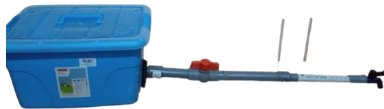
Gambar 3. 2 Desain Awal KIT Praktikum venturimeter
