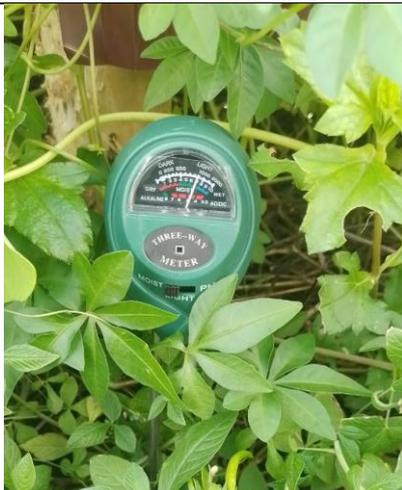
(Gambar: Soil Meter untuk Mengukur pH dan Kelembaban tanah)
