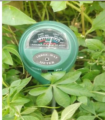
(Gambar: Soil Meter untuk Mengukur pH dan Kelembaban tanah)
