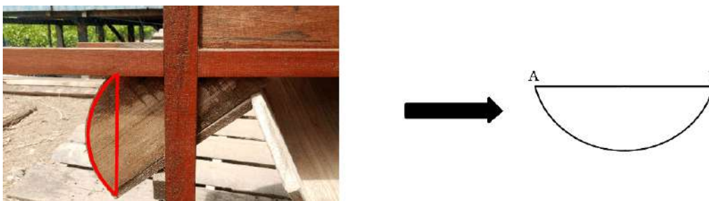
Gambar 4. 30 Konsep Setengah Lingkaran pada Outlet Pembuangan Gumbaan.
