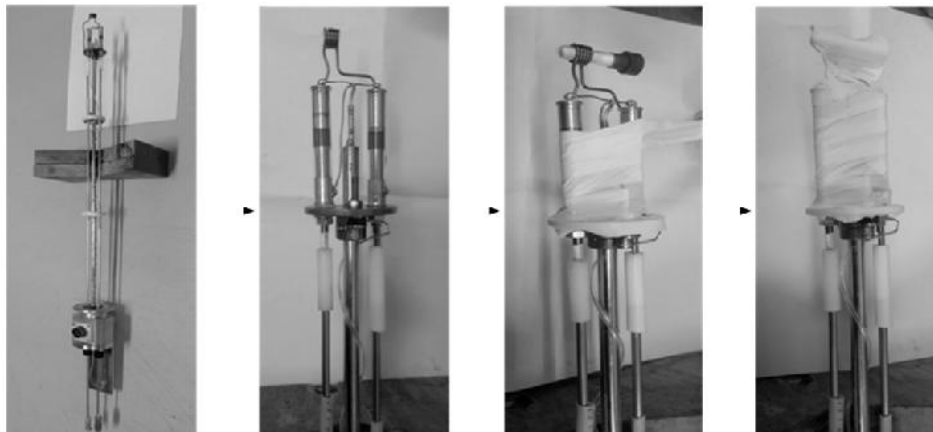
Gambar 2. Proses perakitan probe NMR yang terdiri atas kapasitor, induktor, sampel dan termokopel (Suwandi, 2014).
