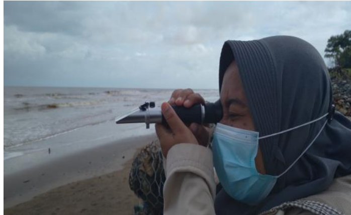
Pengukuran salinitas air menggunakan alat refraktometer Sumber: Dok. Pribadi (2021)
