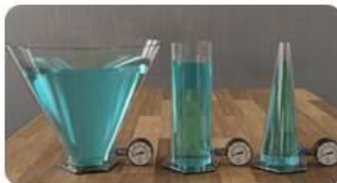
Gambar 1.2 Tekanan Hidrostatik pada 3 bejana dengan bentuk yang berbeda (Sumber: sinaumaning.vercel.app)
