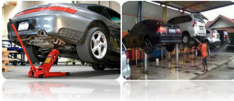
Gambar 14. Dongkrak Hidrolik mengangkat mobil Sumber: (Marketiva, 2020) https://www.ruparupa.com/blog/tips-memilih-dongkrak-mobil-terbaik/
