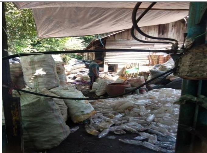
Proses pemotongan label pada sampah gelas plastik.
