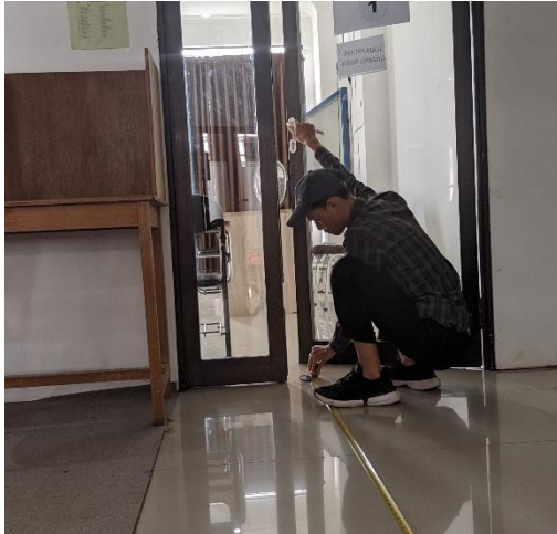
Pengukuran luas bangunan dan pengukuran untuk mendapatkan titik penentuan pengambilan pencahayaan.
