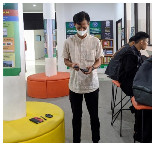
Pengukuran intensitas pencahayaan menggunakan lux meter.
