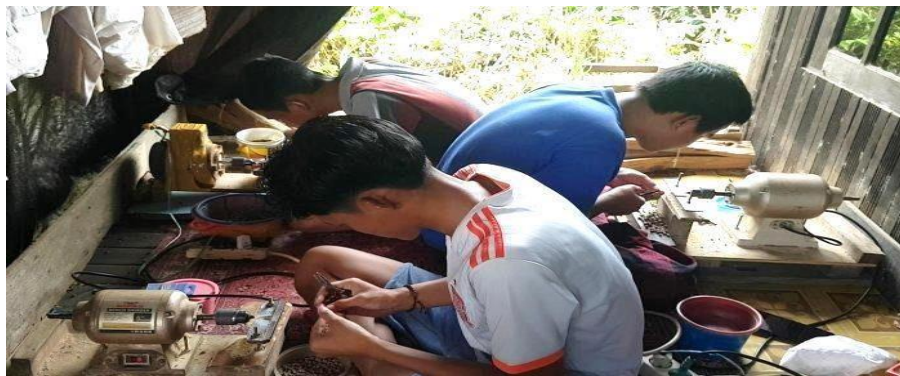
Proses membuat lubang pada butiran gelang
