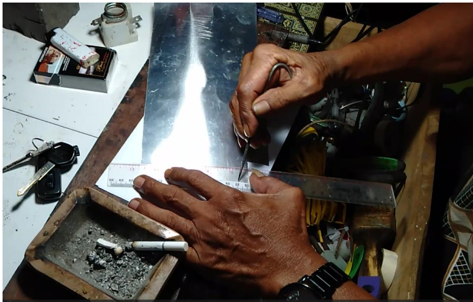
Proses perancangan piringan kompas dari plat aluminium.
