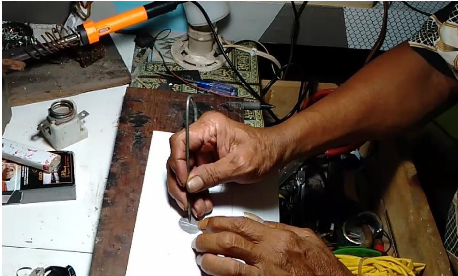
Proses pembuatan lubang untuk poros jarum magnet
