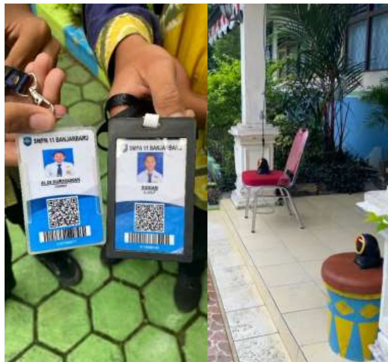
Gambar 10 Kartu Presensi Dan Alat Scanner Qr Code Dan RFID Siswa SMPN 11 Banjarbaru
