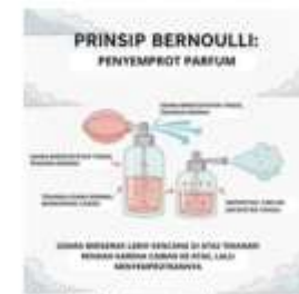
Gambar 4. Penerapan Bernoulli pada Penyemprot Parfum
